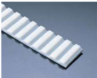
歯の断面を大きくした、高トルク・高張力タイプです。ベルトの歯先がプーリの歯底に圧接するので、多角化が少なく心線疲労が減少します。バックラッシレスプーリとの組合せにより位置決め精度の向上を図れます。
