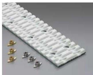
2次アタッチメントを専用ナットでボルト固定するベルトです。ベルトには、専用ナット用のザグリ穴を設けています。必要な位置の穴を貫通させ、2次アタッチメントを取り付けることができます。
