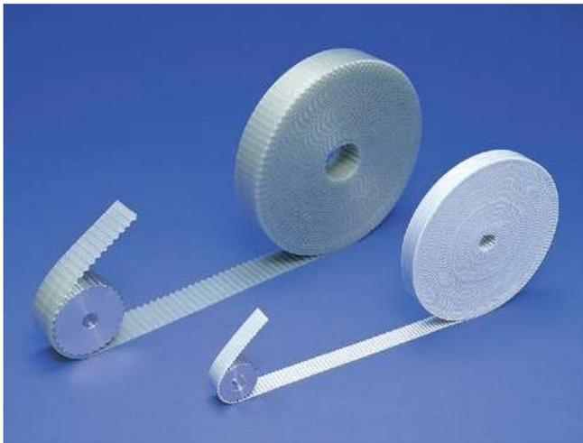
高張カスチール心線（または、アラミッド繊維心線）を平行に配置しアイアンラバーを一体成形した搬送用歯付ベルトで、ご希望の歯数のエンドレス歯付ベルトに融着加工します。
